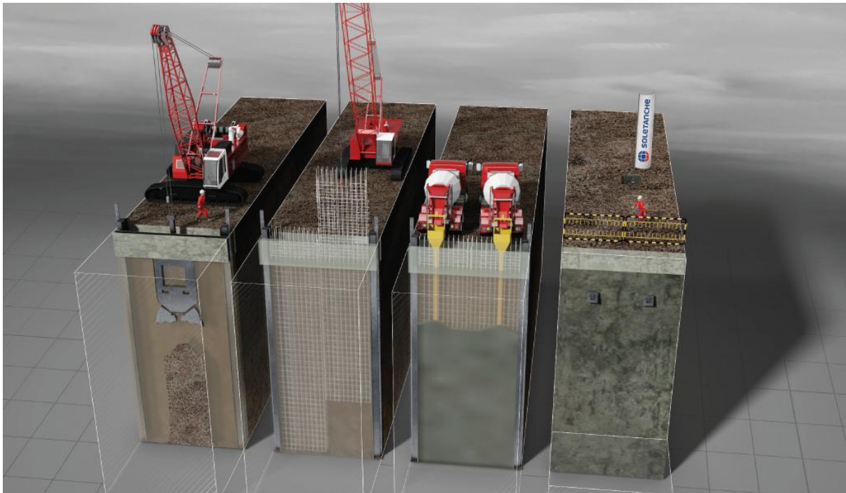
Rys. 1.1 Schemat faz wykonania ścian szczelinowych (Soletanche Polska)
