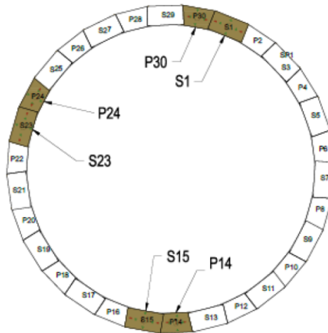
Rys. 5.26 Lokalizacja opomiarowanych sekcji na poletku próbnym nr 4 (źródło: Bachy Soletanche Ltd.)
