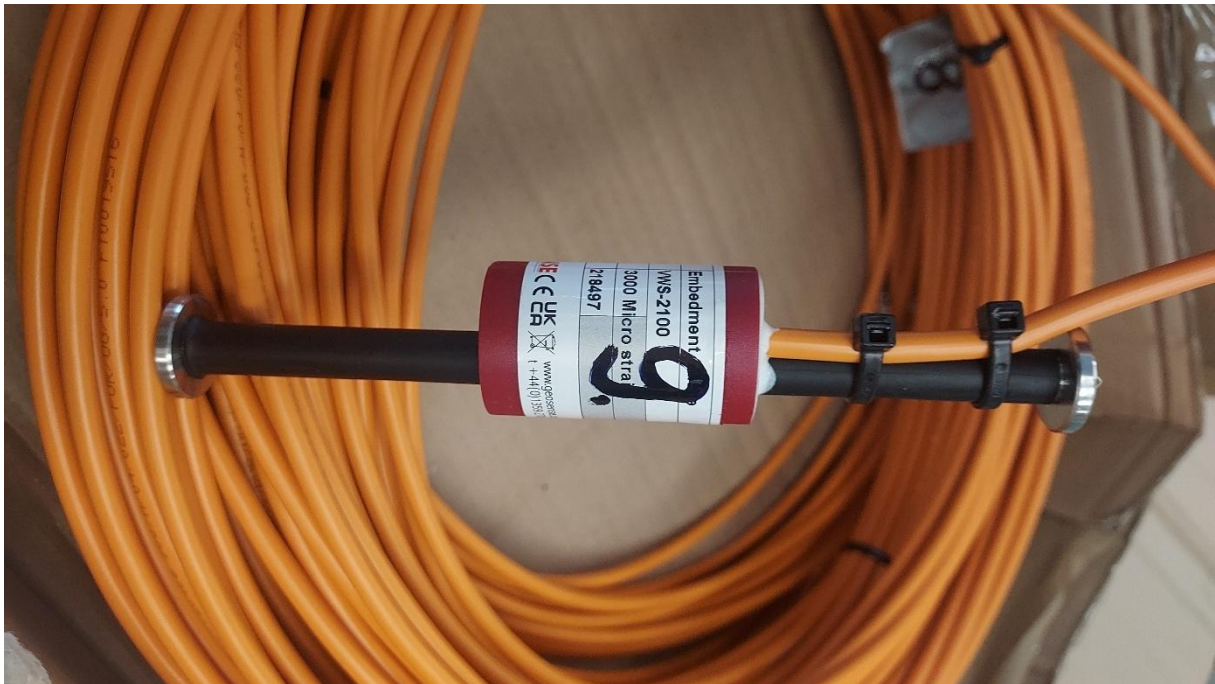
Rys. 5.3 Czujnik strunowy do montażu w betonie (fot. Autora)
